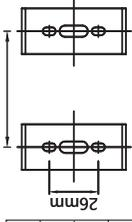
③ 6 mm Dübel in die Wand einsetzen, Befestigungswinkel mit M4 Schraube befestigen
